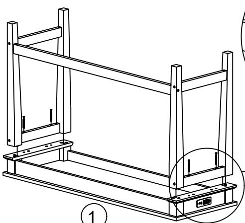
**FULLY TIGHTEN ALL THE BOLTS / SERREZ LES VIS COMPLÈTEMENT**
